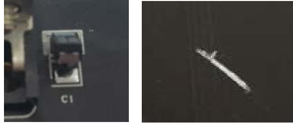
그림 3.3. 부품 탈락 및 외부 손상 상태 예시
