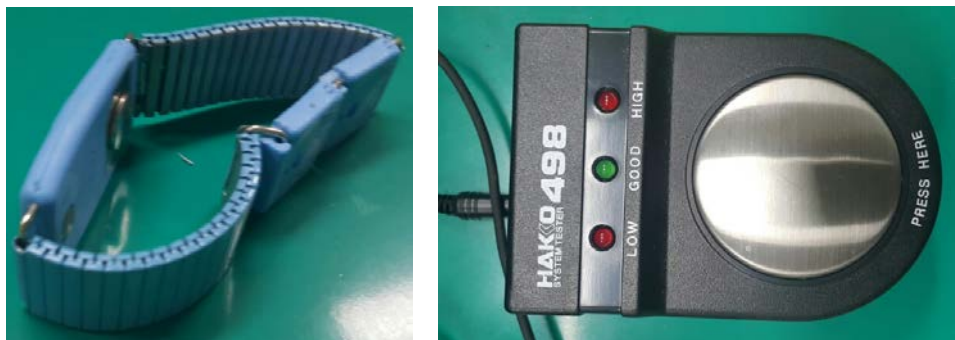
그림 3.2. 정전기 방지 밴드 및 테스터
